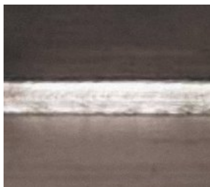
Soldagem MAG mecanizada
