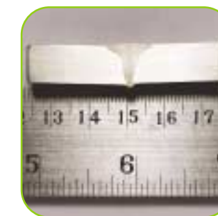
Perfil de penetração junta topo a topo.
