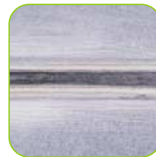
Aspecto da face da solda junta topo a topo chapa galvanizada esp. 1mm vel. 1.600mm/min.
