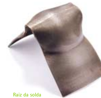
Raiz da solda junta topo a topo esp. 1,5mm aço carbono.
