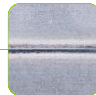
Aspecto da raiz da solda junta topo a topo chapa galvanizada esp. 1mm vel. 1.600mm/min.
